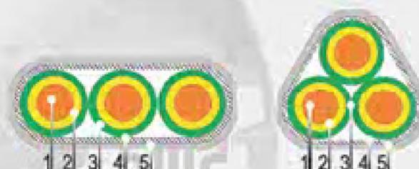
Кабели предназначены для эксплуатации в скважинной жидкости, содержащей нефть, а также воду и газ со следующими показателями:
